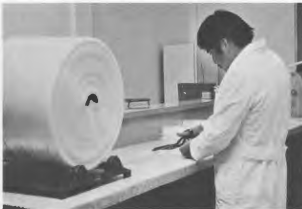
Figura 9. El aparato de rodillo facilita cortar los tubos para las cajas de postura de huevos de taladrador.
