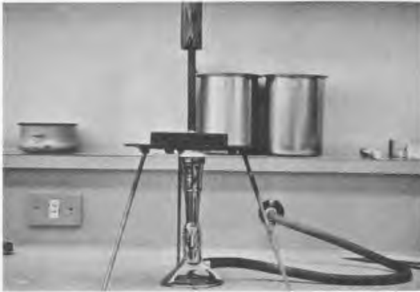
Figura 4. Un hierro marcador caliente se usa para perforar la tapa del recipiente para crianza. Un cauldín se usa para derretir la malla dentro de las tapas.
