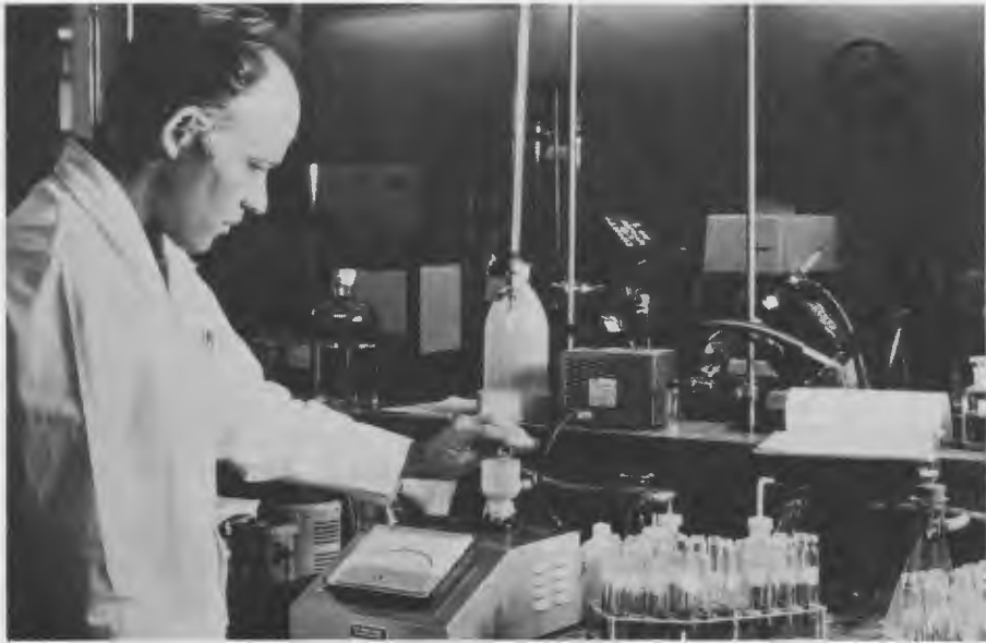
Lectura del por ciento de trasmitancia en la evaluación del índice de calidad proteínica.
