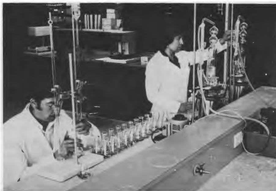
Destilación por arrastre de vapor y titulación del amonio.
